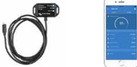
Con VE.Direct alla chiave elettronica dongle Bluetooth Smart, i dati e gli allarmi in tempo reale possono essere visualizzati sugli smartphone Apple e Android, sulle tablet, sui macbook e su altri dispositivi elettronici.
